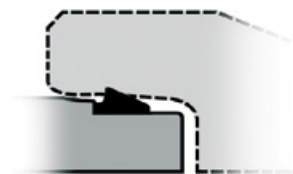
Tipo Ring-GS sezione a cuneo per giunto tornito tipo "CNZ" o a strisciamento
