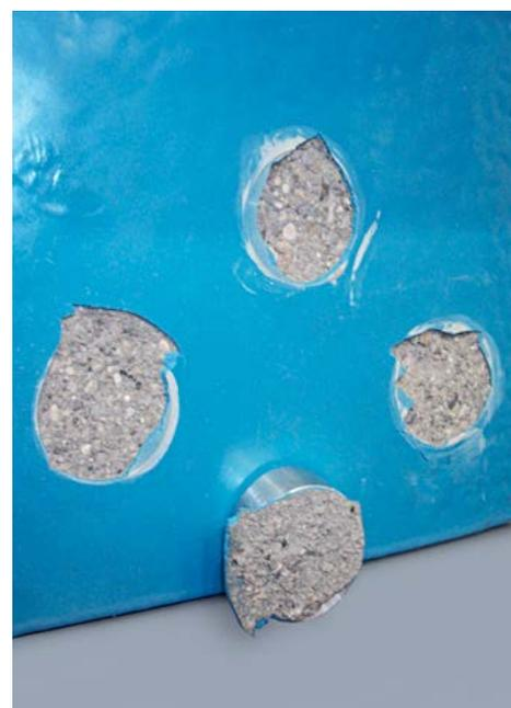
Il test di trazione diretta secondo UNI EN 1542, ha evidenziato che il prodotto non si stacca dal cls ma crea un legame superiore alla resistenza stessa del cls a trazione. La resistenza a trazione di 4,50 MPa con rottura di tipo A (di coesione nel supporto) è ampiamente superiore a quella richiesta per tutti gli utilizzi previsti dalla norma.
