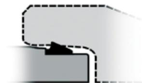
Tipo **Ring-GS** sezione a cuneo per giunto tornito tipo "CNZ" o a strisciamento
